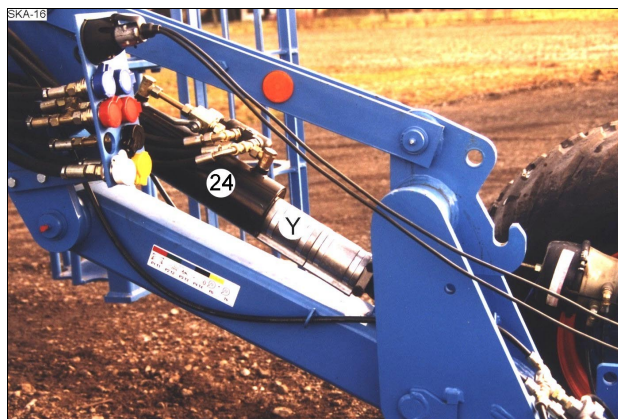
Munkaállás, beállító ütközők (Y) a dugattyúrúdra feltolva.
