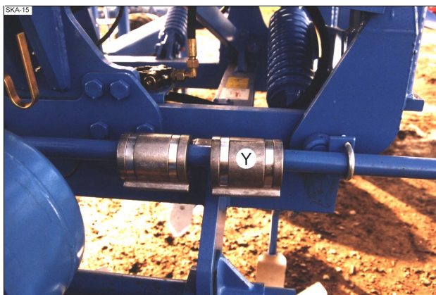
Munkaállás, beállító ütközők (Y) a világítási berendezés első tartójára feltolva.
