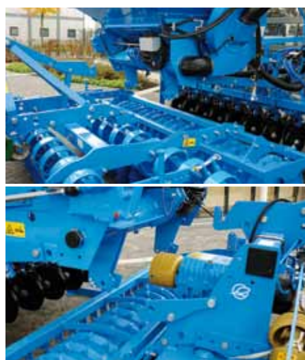
A Heliodor rövidtárcsán (fent) és a Zirkon forgóboronán (lent) lévő univerzális csatlakozás biztosítja azt, hogy a vetőgépet gyorsan át lehet szerelni egy talajművelő eszközről a másikra.
