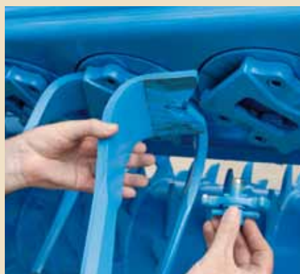
A fogak cseréje a gyorscserélő rendszer segítségével
