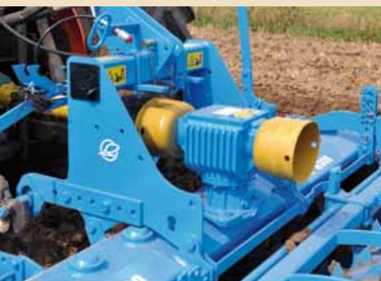
Egyszerű erőátvitel a cserekeres hajtóművel
